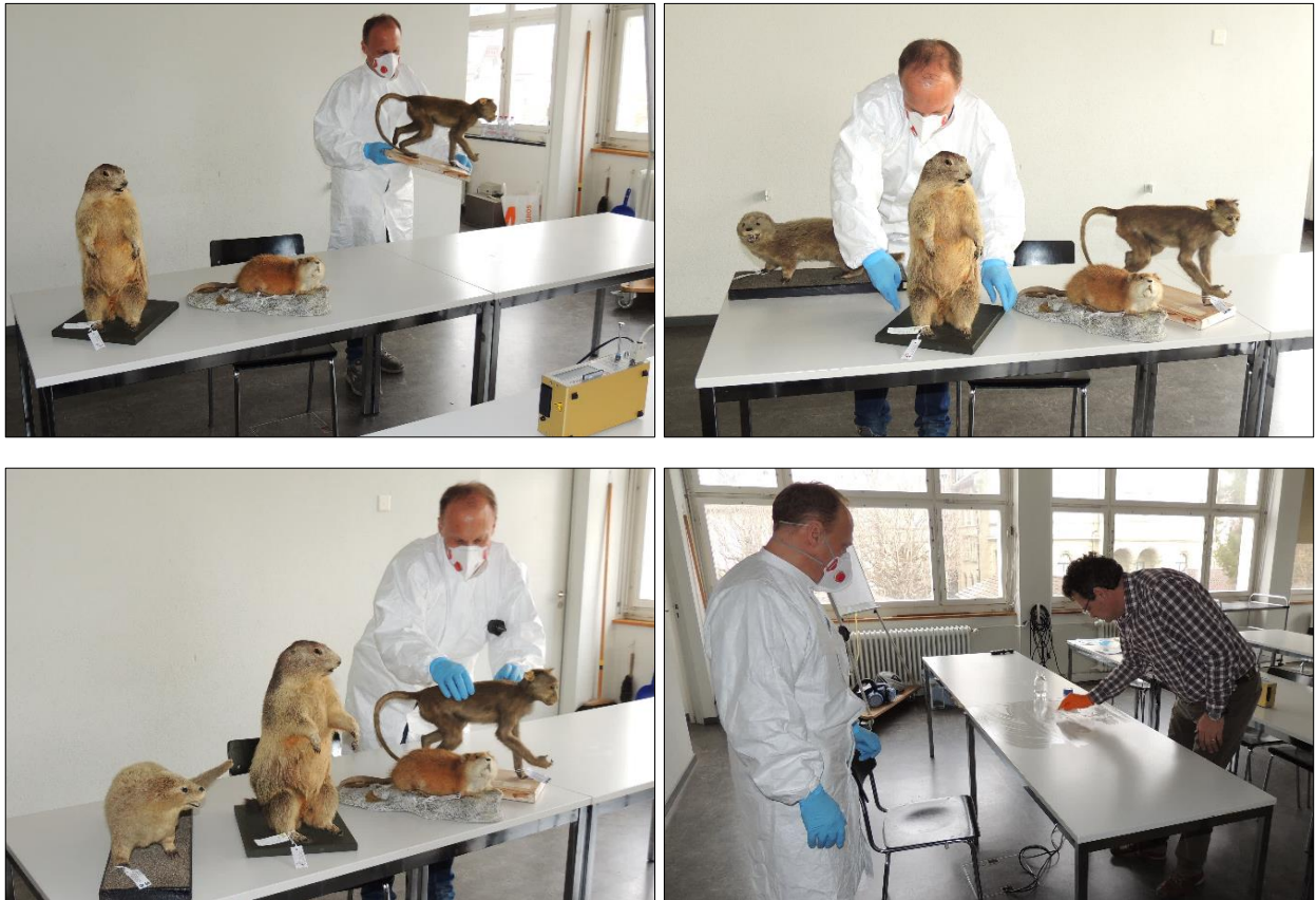
Abb. 8: Simulationsversuch im Schulunterricht mit Säugetierpräparaten. Am Ende der Schulstunde wurde der Staub auf dem Manipulationstisch beprobt (rechts unten)
