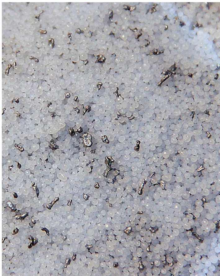
Abbildung 2: Typischer granulatformiger Ablaufreiniger (weisse Körner: Natriumhydroxid / graue Körner: Aluminium)
