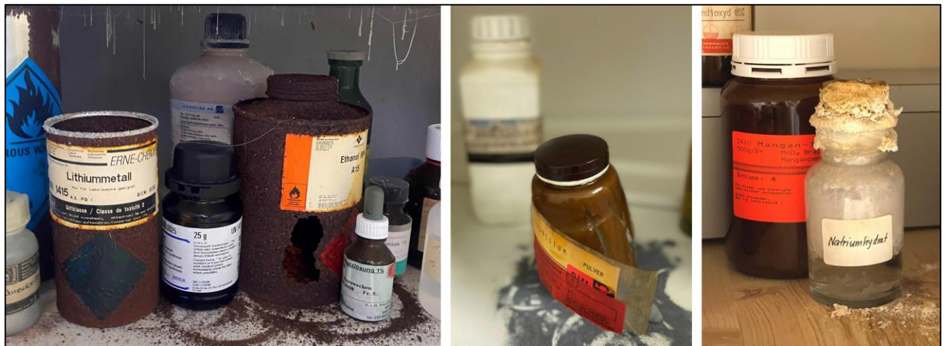
Abbildung 5: Vernachlässigte Chemikaliensammlungen mit korrodierten, zerbrochenen oder undichten Chemikaliengebinden
