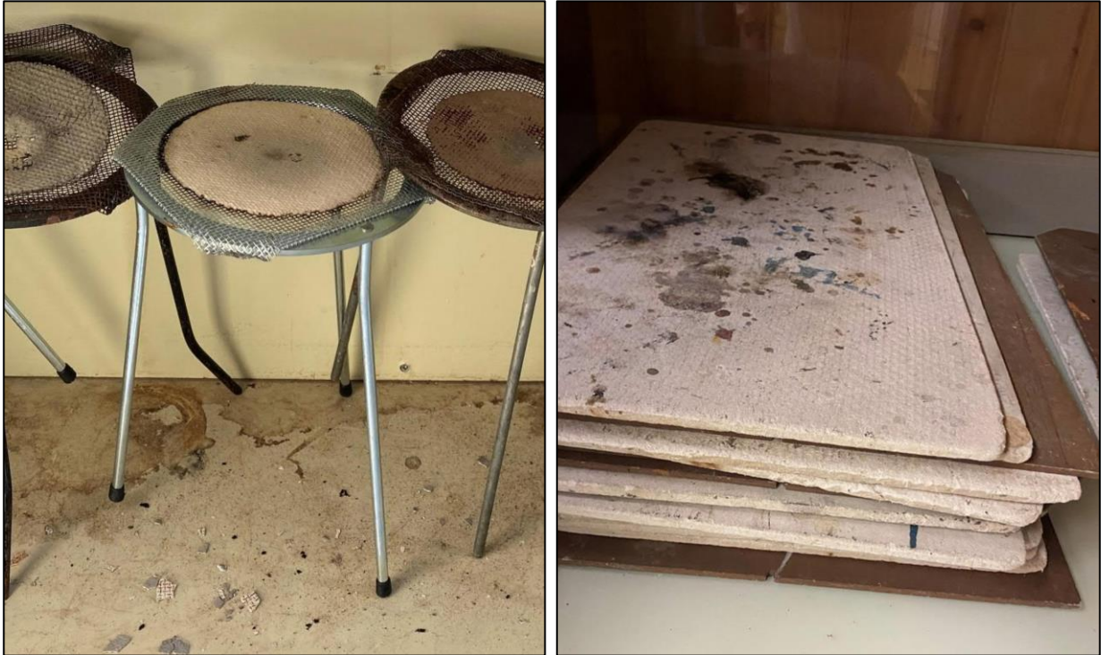
Abbildung 8: Drahtnetze mit asbesthaltiger Beschichtung (links) und feuerfeste Unterlagen aus asbesthaltigem Material (rechts)
